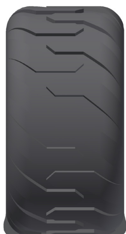
Falta de pressão
